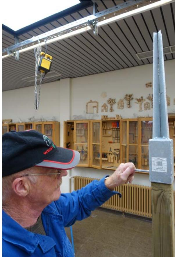
Die zu langen „Pfostenschuhe“ aus verzinktem Stahl , die als Bodenanker benötigt werden, werden eingekürzt. Ein Balken muss neu abgelängt werden, er ist nicht genau genug
