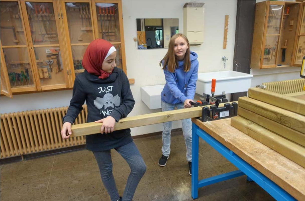
Zusägen der in Gehrungsladen sicher eingespannten Balken mit Japansägen
